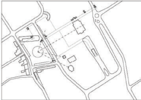
Ryc. 26. Koncepcja poprawy obsługi komunikacyjnej z systemem przejść podziemnych i lokalizacją podziemnego parkingu Źródło: opracowanie M.Sidoruk-Gościcka, 2014
